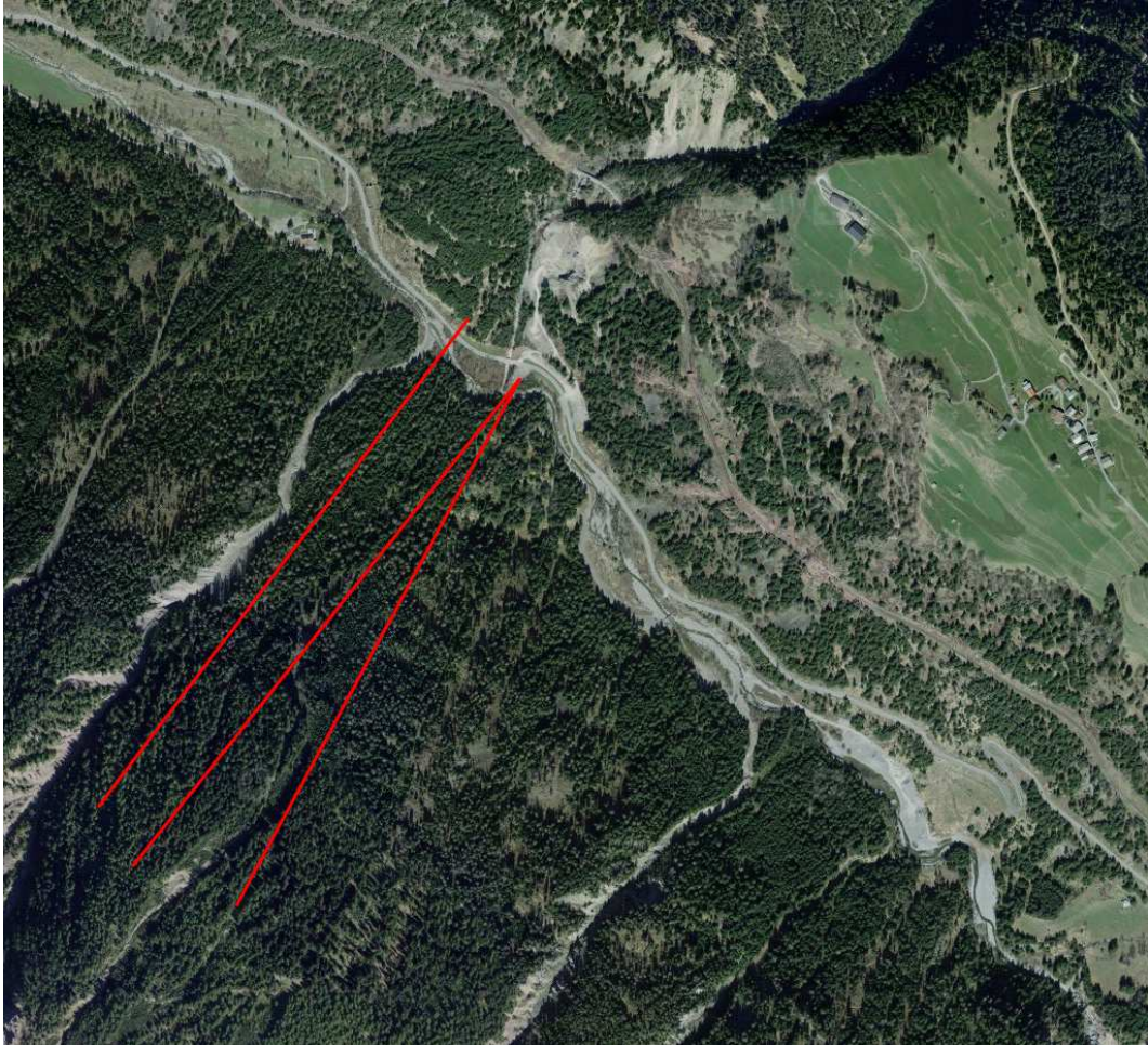
Für den Holztransport wurden im Gebiet «God Ars» drei Seillinien mit dem Langstreckenseilkran installiert. Am rechten Bildrand ist die Fraktion Stuls erkennbar.
